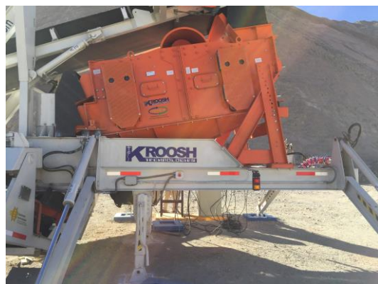
ULS2814.21. Переработка отвалов обогащения медной руды по классам < 1 мм, Чили.
